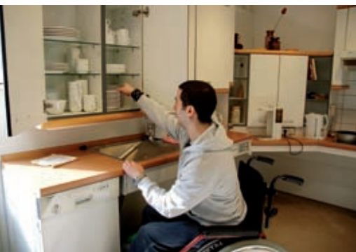
Barrierefreiheit: Elektromotorisch betriebene Oberschränke können bis zur Arbeitsplatte abgesenkt werden.
